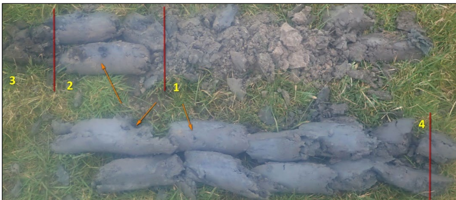
Afbeelding 12. Foto van boring 4. 1: opgebrachte grond; 2: opgebrachte grond; 3: bouwvoor; 4: matig siltige klei (kwelderafzetting); oranje pijl: humeuze vlekken
