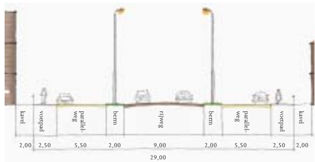
heliconweg ter hoogte van woningen
