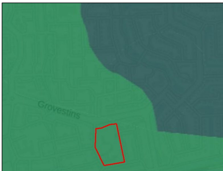
Afbeelding 2. Uitsnede van de bodemkaart waarop het onderzoeksgebied met een rood kader is aangegeven. Groen: knippige poldervaaggronden van zware klei, donkerblauw: drechtvaaggronden.
