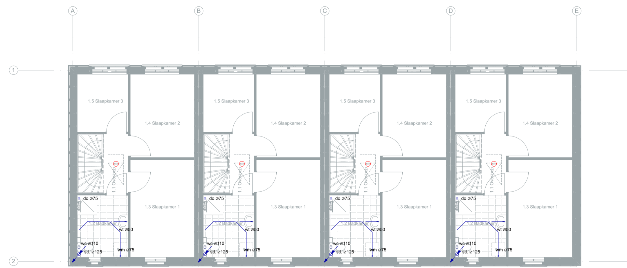
plattegrond overzicht BEGANEGROND - RIOLERING
