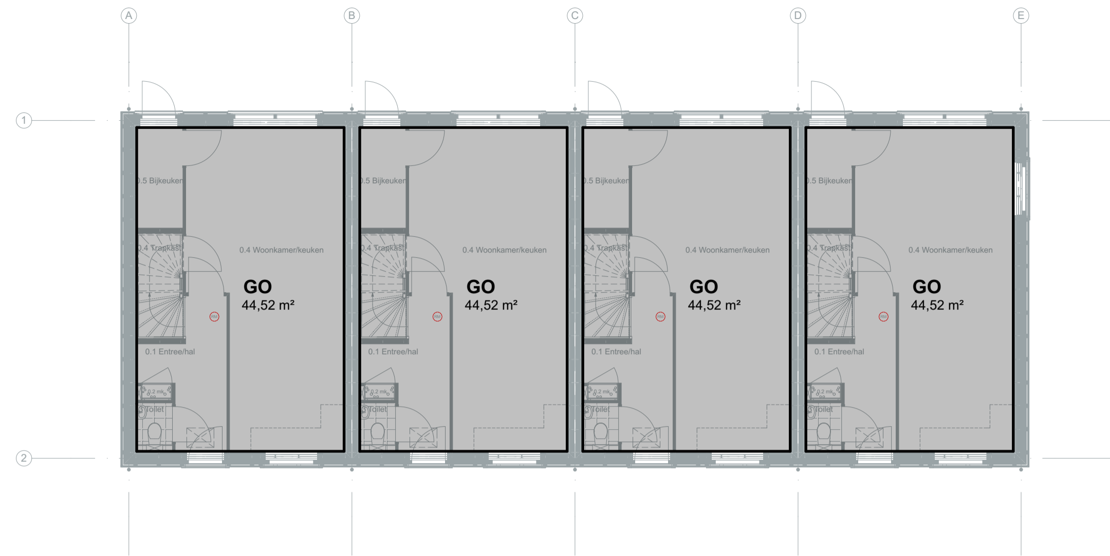
plattegrond overzicht BEGANEGROND - GEBRUIKSOPPERVLAK
