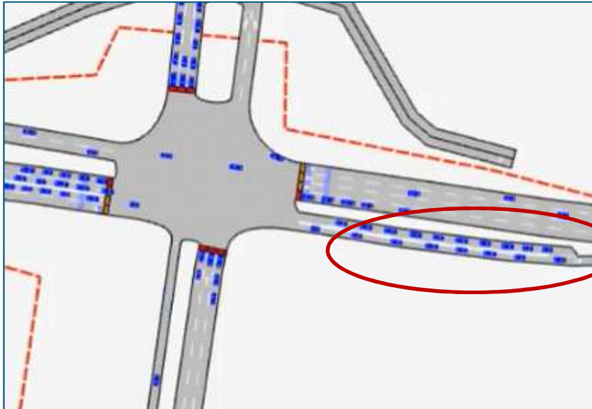
Figuur 8: Kruispunt Westeinde, beperkte afrijcapaciteit samenvoeger
