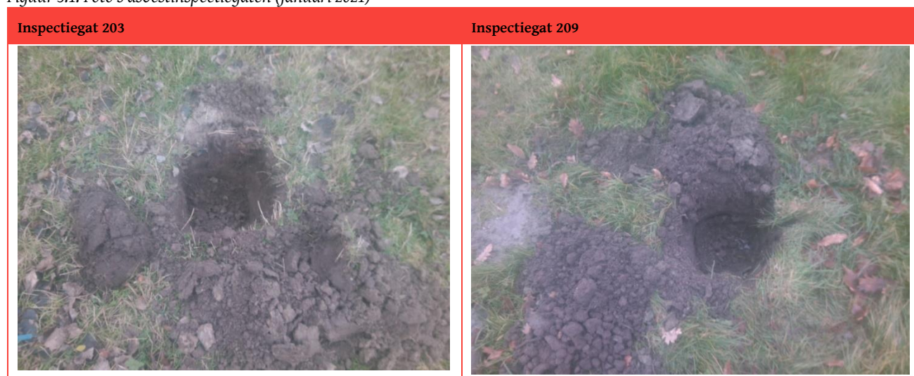
Figuur 3.1: Foto's asbestinspectiegaten (januari 2021)
