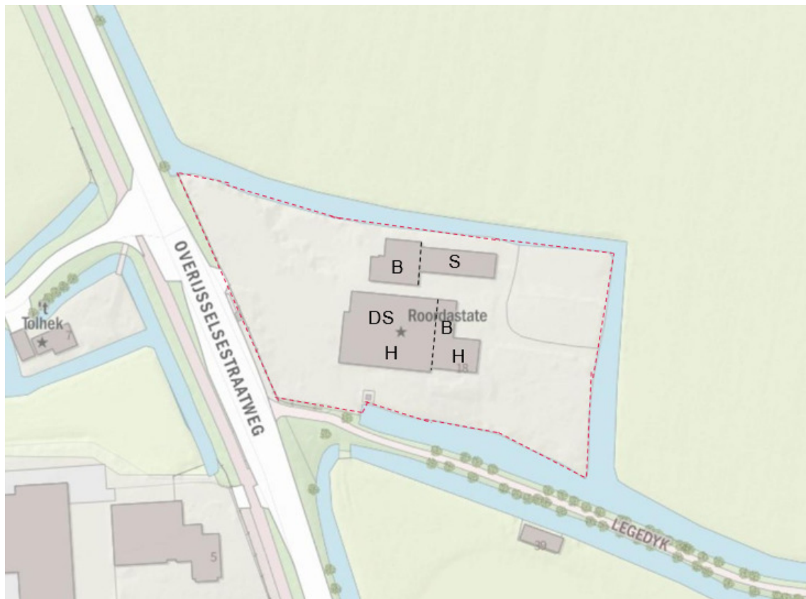
Figuur 3.5: Schets van het plangebied (rode gestippelde contour) met daarop de te slopen (S), te behouden (B) gebouwen en de te herinrichten (H) gebouwen. Van de romp van de boerderij wordt een deel van het dak vervangen (DS). (bron: Pdok.nl)
