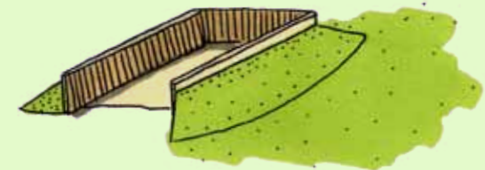
Sleufsilo inpassen met lage grondwal
