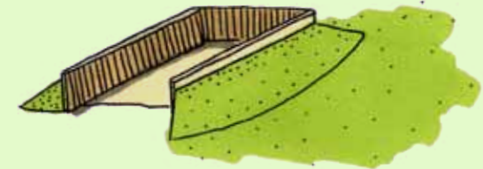
Sleufsilo inpassen met lage grondwal
