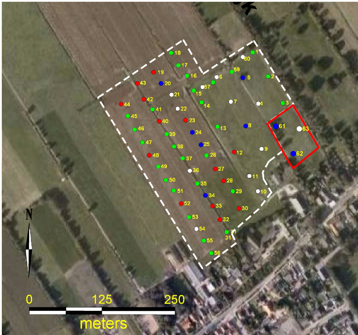
Figuur 8. Nieuwehorne, Uitbreiding Sportcomplex: Boorpuntenkaart op basis van de luchtfoto uit GoogleEarth. Het plangebied is aangegeven met een witte onderbroken lijn. De uitbreiding van het plangebied is rood omlijnd. De rode punten geven de boringen aan waar een intact podzolprofiel onder een veenlaag is waargenomen. De blauwe boorpunten geven aan waar een intact podzolprofiel zonder afdekkende laag veen is gevonden. De groene boorpunten geven aan waar een gedeeltelijk intact podzolprofiel zonder afdekkend veen en zonder E-horizont is gezien. De witte boorpunten geven een tot in de C-horizont verstoord profiel aan.
