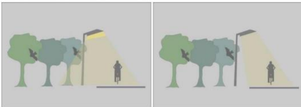
Figuur 7: Voorbeeld gerichte verlichting. Links: ongerichte verlichting. Rechts: gerichte verlichting waarbij lichtverstoring wordt voorkomen. Bron: Zoogdiervereniging.nl
