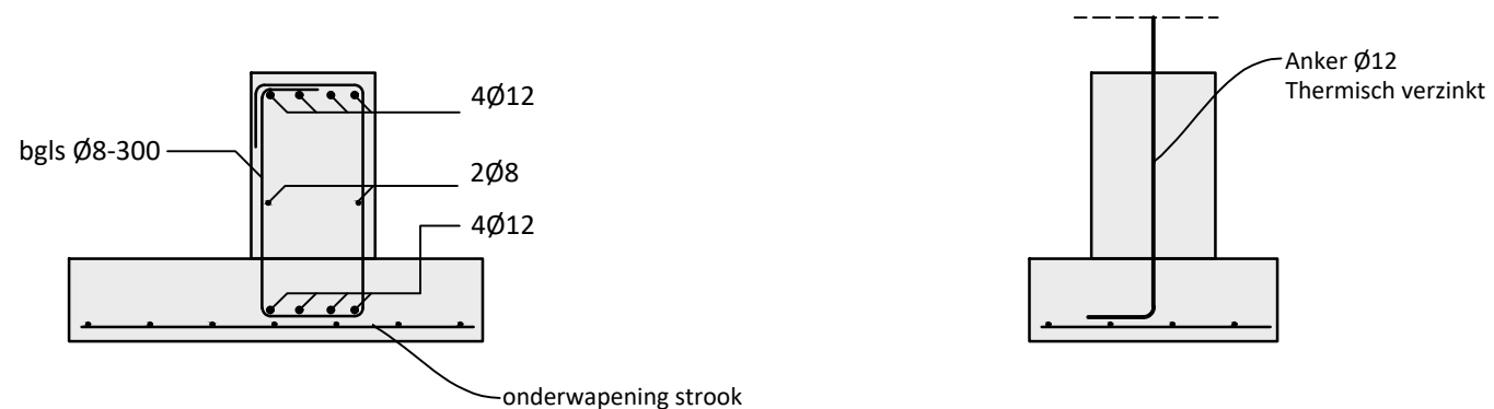
Balk voorzien van wapening
