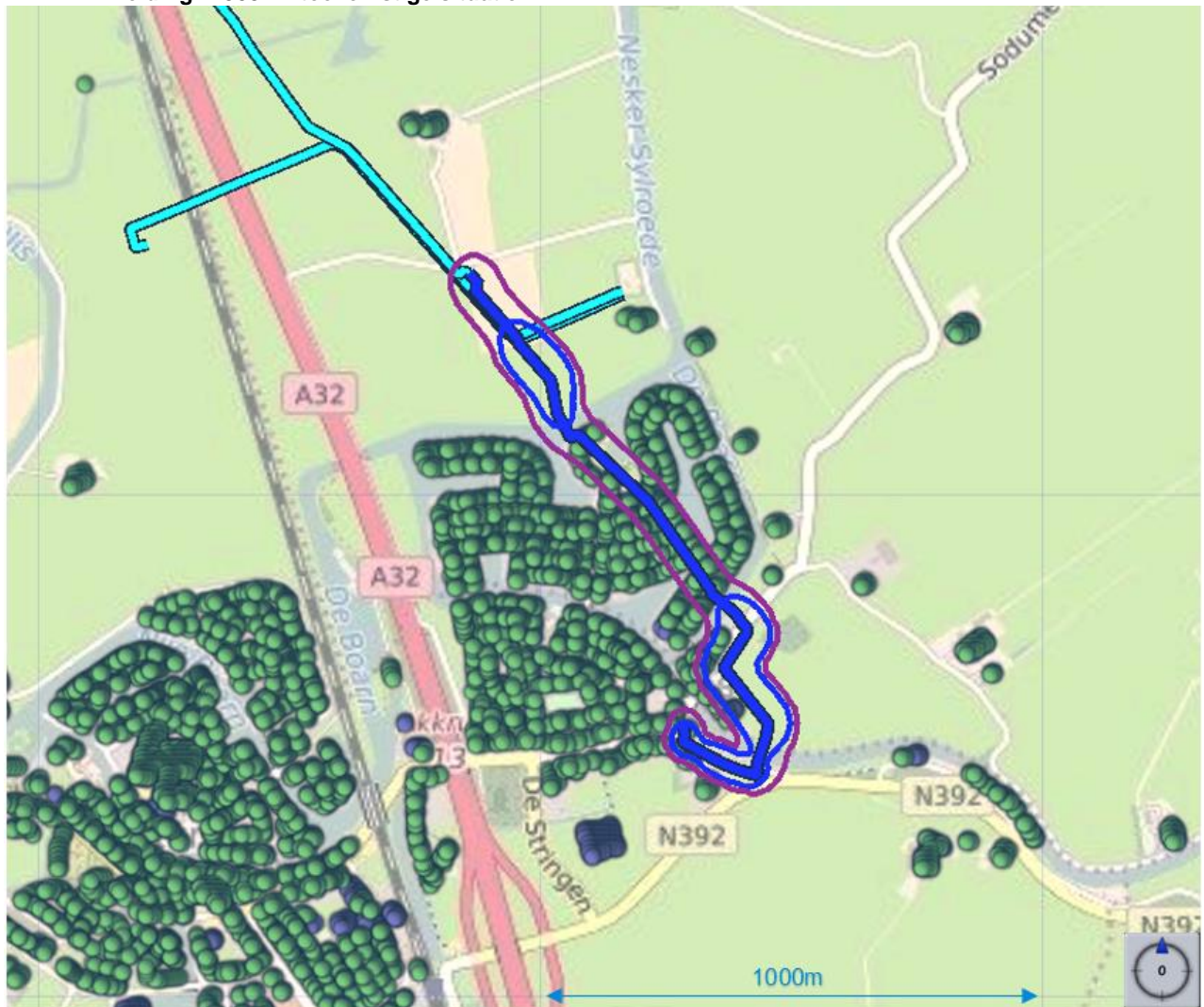
Figuur 12 Ligging van gastransportleiding N-503-71 (donkerblauw) in de toekomstige situatie. De plaatsgebonden risicocontouren rondom de leiding zijn, wanneer aanwezig, weergegeven met de volgende kleuren:
