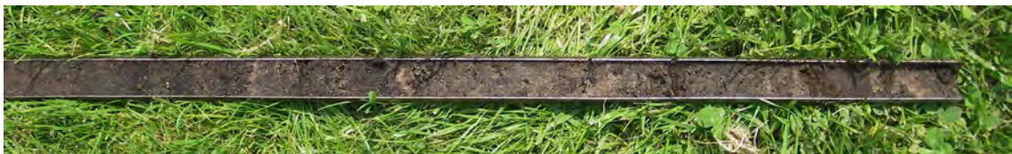
Figuur 7: Heerenveen, Heerenhage: De sterk vergraven top van het veenpakket zoals dit in boring 9 is aangetroffen.
