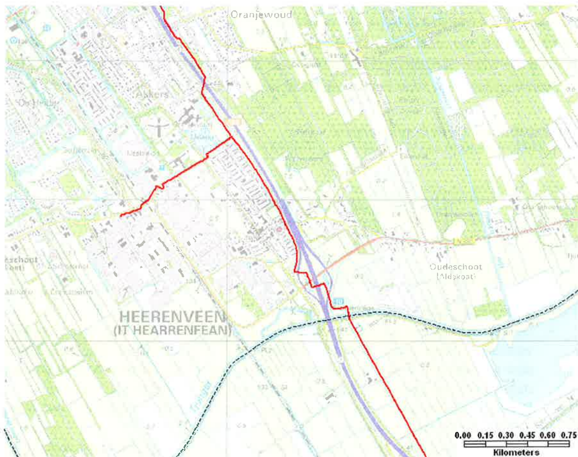
Figuur 1 Een 10^{-6} contour ontbreekt omdat het plaatsgebonden risico voor de gebruikte stationing nergens groter is dan 10^{-6} per jaar.
