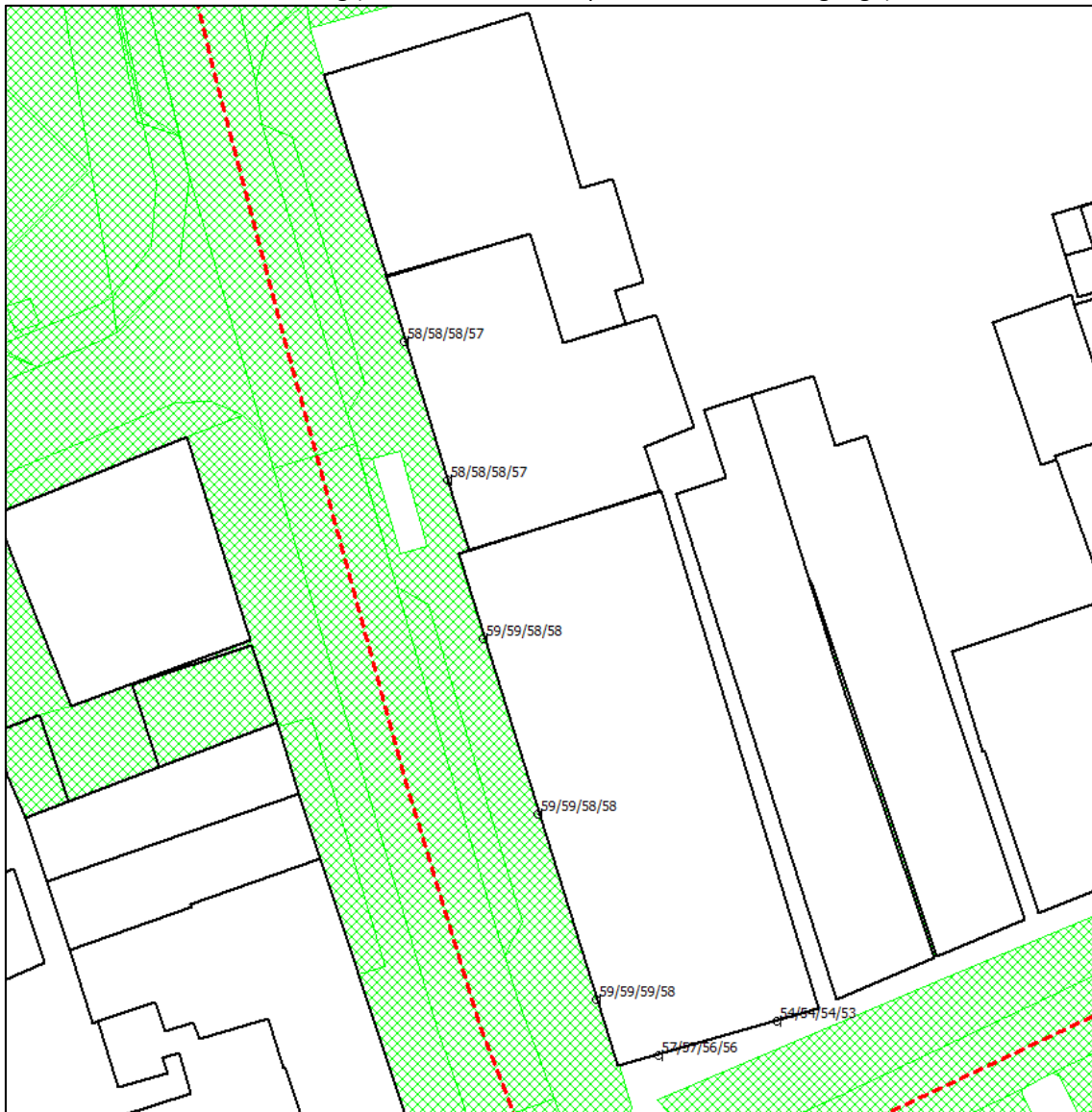
Figuur 5.1: overzicht van de berekende geluidbelasting L_{den} in dB vanwege de Nieuwstraat Koornbeursweg (inclusief 5 dB aftrek op basis van artikel 110g Wgh)
