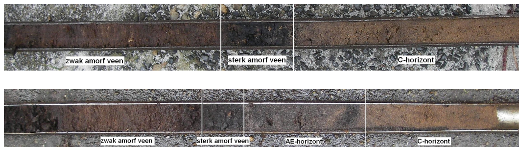
Figuur 5: Boorkernen van boring 39: 1,0 - 1,4 m beneden maaiveld (boven) en boring 59: 1,3 - 1,7 m beneden maaiveld (onder). Bij beide kernen is de linkerkant boven. De breedte van de guts is 2 cm. Ter plaatse van boring 39 heeft nauwelijks bodemvorming plaats gevonden in het zand, ter plaatse van boring 59 wel: humeuze aanrijking en uitspoeling (AE-horizont). Aangezien een duidelijk herkenbare inspoelingshorizont (B) ontbreekt, is van een podzolbodem nog geen sprake.
