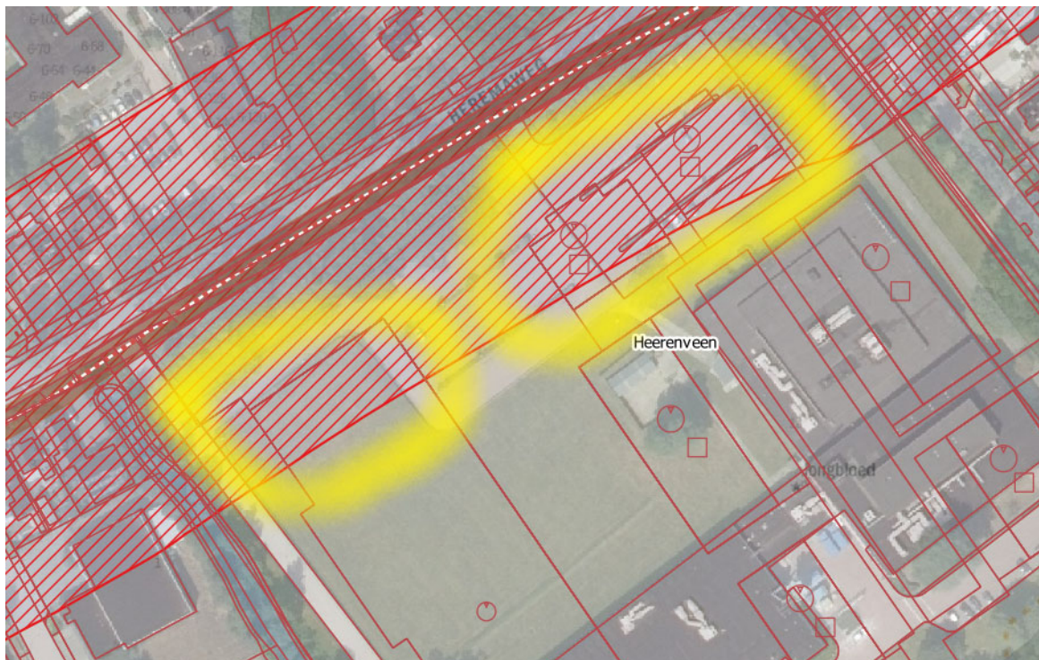
Figuur 7: Woningen en bedrijfsgebouw (geel gemarkeerd) binnen invloedsgebied(rode schuine lijnen) aardgasleiding N-500-17 (rood-witte lijn)
