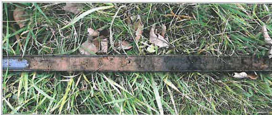
Figuur 6: Heerenveen, Breedpad: foto van de bodemopbouw (diepte 150-190 cm) in boring 2 zoals deze zichtbaar was in de guts. De bovenkant van het profiel is op de foto rechts; links is het einde van de boring te zien. Het bovenste, donkerbruine deel van de boring bestaat uit veen. Hieronder bevindt zich een zwarte smeerlaag die het begin van de veenvorming markeert. Onder de smeerlaag bevindt zich het gele dekzand. De donkere vlek bovenin het dekzand is een leemlaag. Te zien is dat in het dekzand geen bodemvorming heeft plaatsgevonden.
