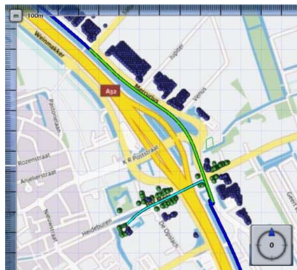
Figuur 18: Overschrijding van het groepsrisico als functie van de stationing van de N-500-20.
