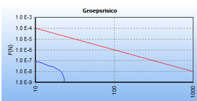
Figuur 15: FN-curve van de kilometer met de hoogste overschrijdingsfactor van gastransportleiding N-500-20 in de huidige situatie. De ligging van deze kilometer is hiernaast in het groen weergegeven op een topografische kaart.
