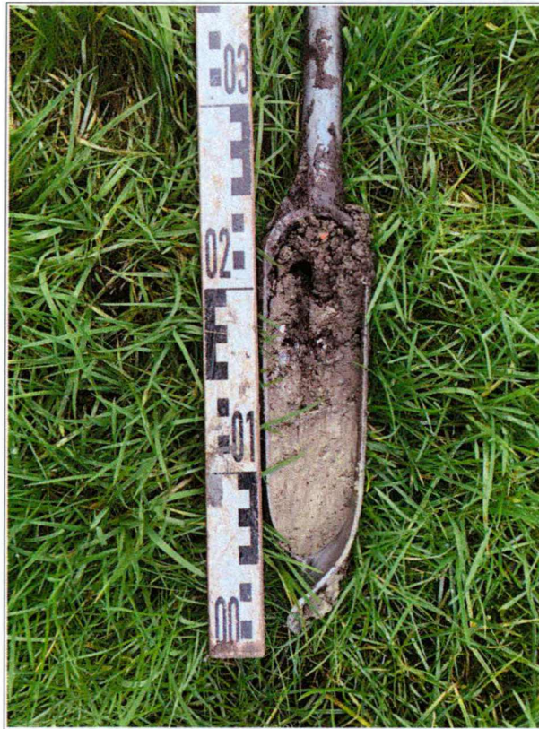
Figuur 18. Harlingen, Oude Trekweg 34b: De opgeboorde grond uit boring 2 met de ophogingslaag uit de nieuwe tijd (donkergrijze laag in de boorkern) op de kwelderafzettingen (lichtgrijze laag in de boorkern) op een diepte van circa 70 centimeter beneden maaiveld. In dit pakket zijn archeologische indicatoren gevonden waaronder baksteenpuin, mortel, houtskool en aardewerk uit de late middeleeuwen – nieuwe tijd.
