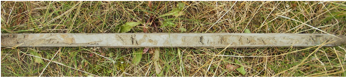
Figuur 5. Harlingen, Dukdalf-locatie. De gelaagde getijde-afzettingen zoals deze in de onverstoorde ondergrond zijn aangetroffen.
