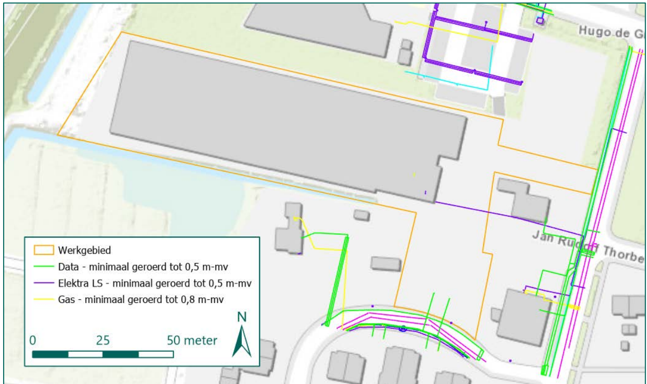
Figuur 8. Kabels en leidingen informatie (Klic-oriëntatie).
