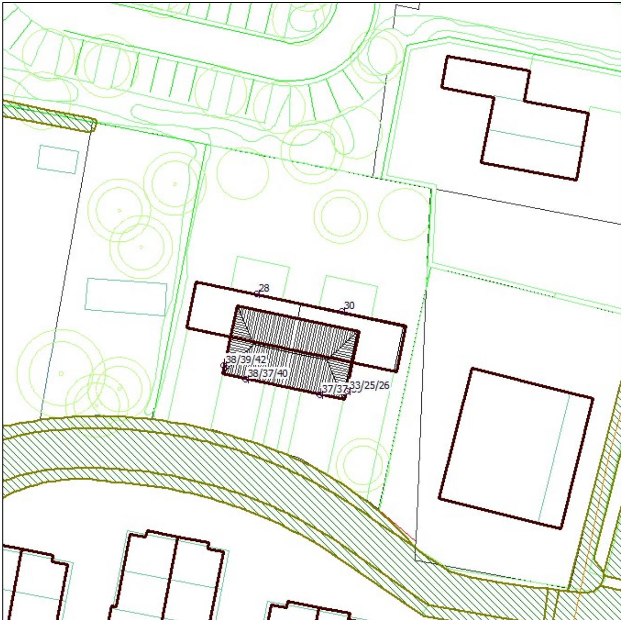
Figuur 2: overzicht van de berekende geluidbelasting vanwege L_{den} in dB vanwege de Kimswerderweg, inclusief 5 dB aftrek op basis van artikel 110g Wgh
