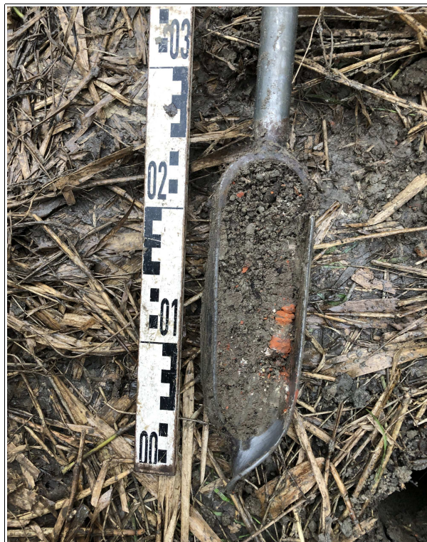
Figuur 19. Harlingen, Westerzeedijk: De opgeboorde grond uit boring 2 met de ophogingslaag uit de nieuwe tijd op een diepte van circa 100 centimeter beneden maaiveld. In dit pakket zijn archeologische indicatoren gevonden waaronder baksteenpuin, mortel en houtskool. Deze boring werd vanwege ondoordringbaar puin beëindigd op een diepte van 130 centimeter beneden maaiveld.
