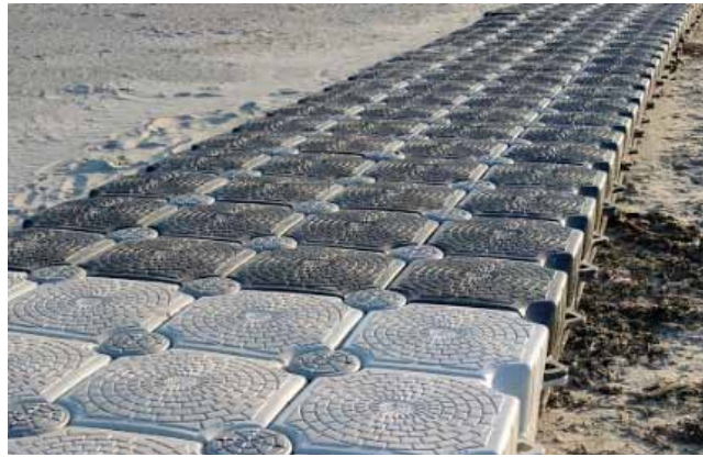
Ponton in combinatie met algenscherm. Onderdeel van een studie die wordt verricht naar de mogelijkheden voor een schoner strand
