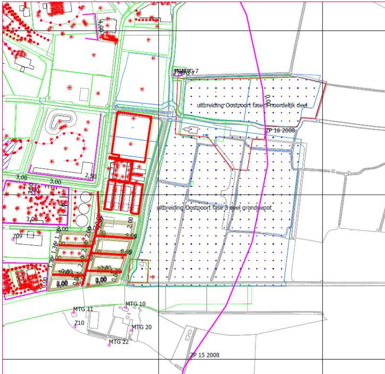
Figuur 2: overzicht akoestisch rekenmodel (zonebeheersmodel FUMO) met ingevoerde kavelbron voor de uitbreiding van Oostpoort fase 3
