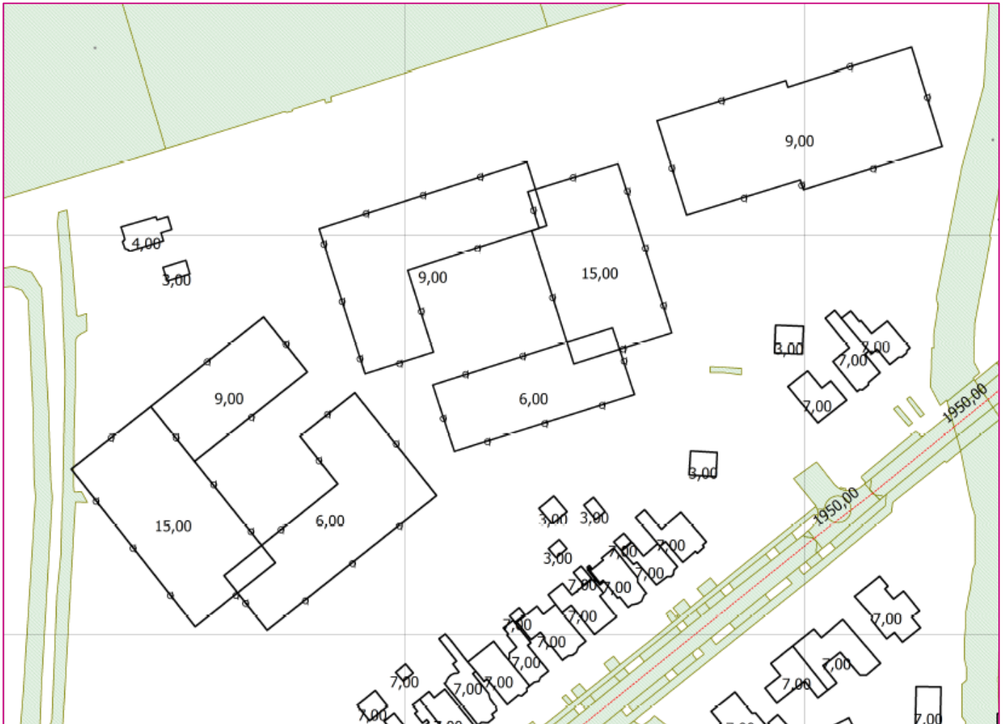
Figuur 4.1: overzicht van het akoestisch rekenmodel met de ligging van objecten, de harde bodemvlakken ( B_f = 0,0 ) en de toets-/rekenpunten
