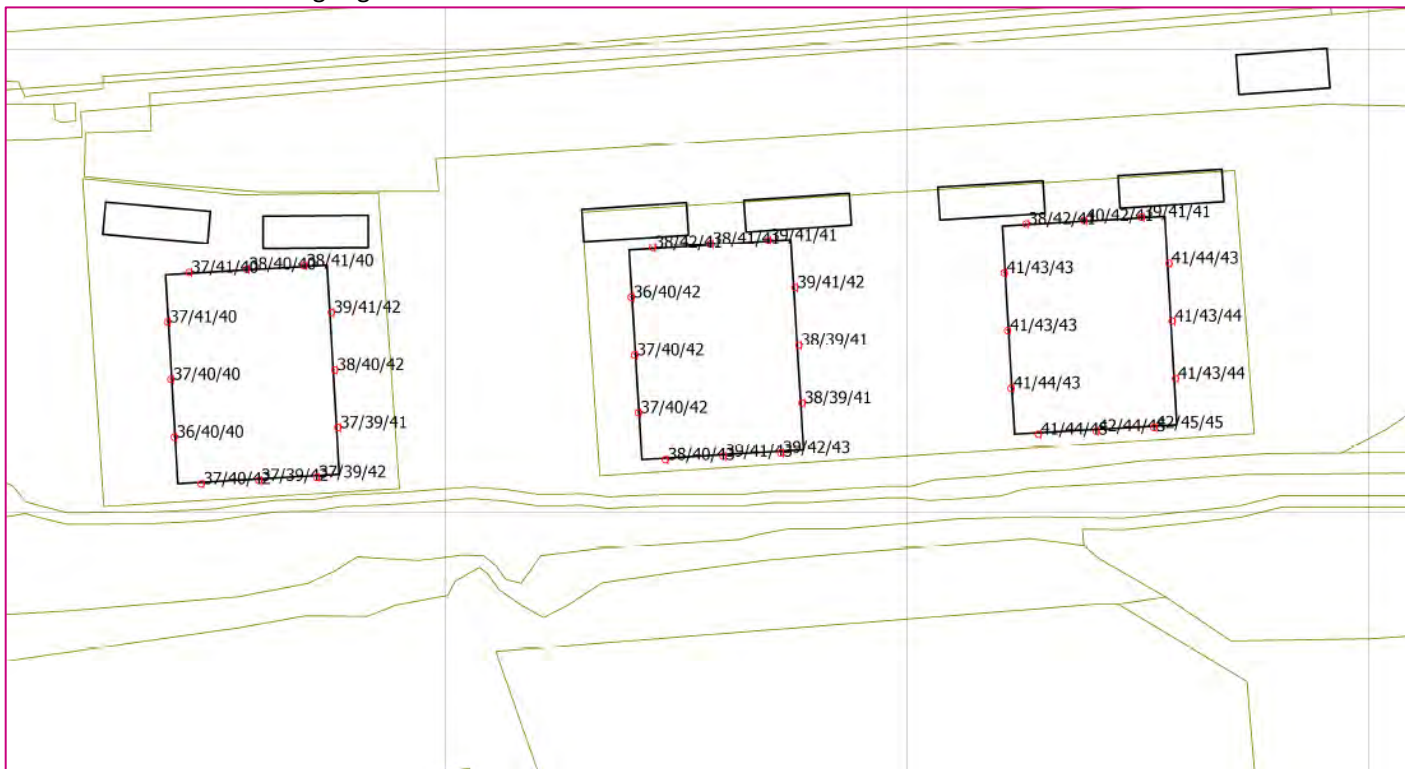
Figuur 5.1: overzicht van de berekende geluidbelasting vanwege de N31 ( L_{den} in dB), inclusief 2 dB aftrek op basis van artikel 110g Wgh
