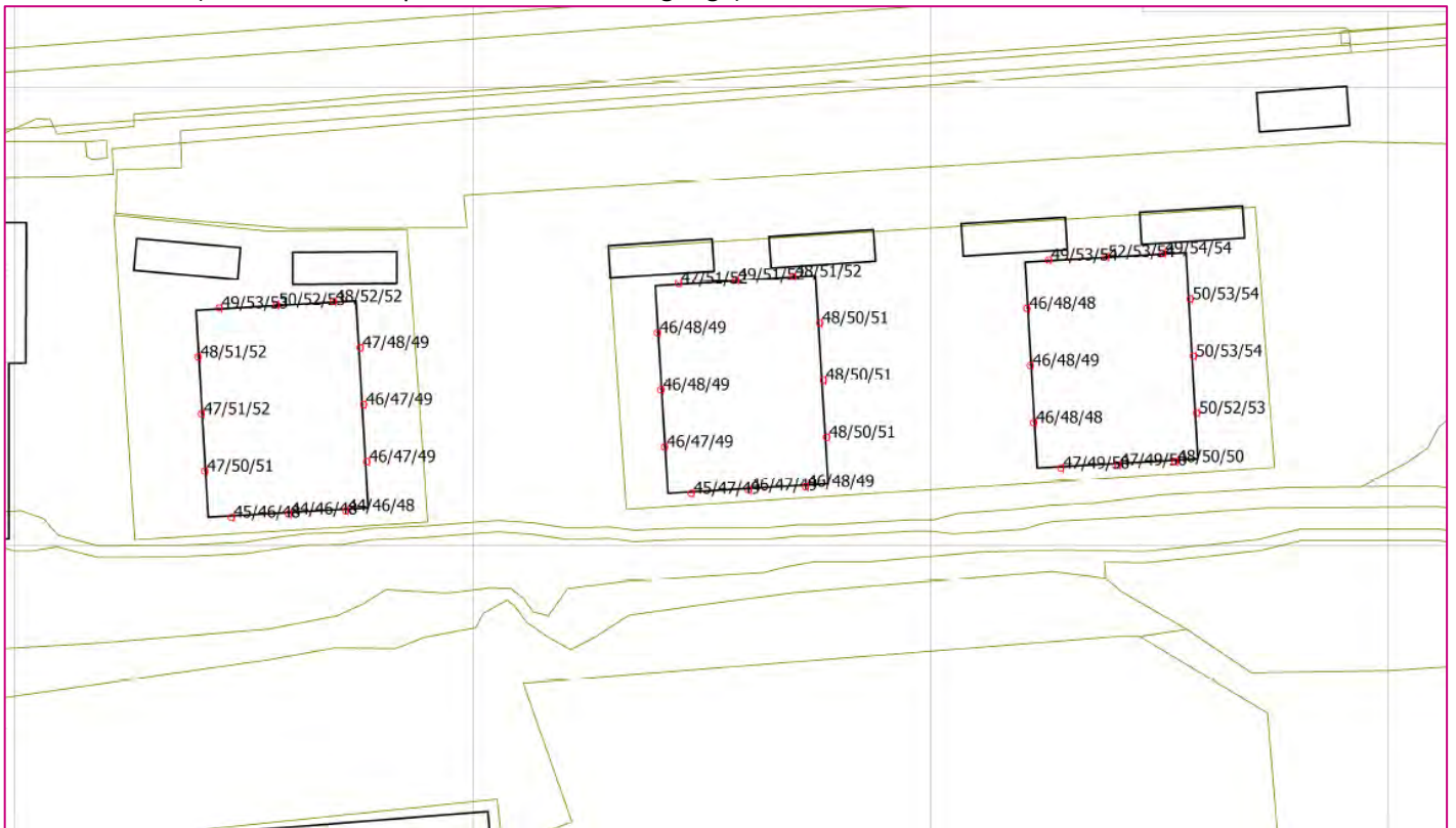
Figuur 5.6: overzicht van de berekende cumulatieve geluidbelasting L_{den} in dB vanwege wegverkeerslawaai (exclusief aftrek op basis van artikel 110g Wgh)
