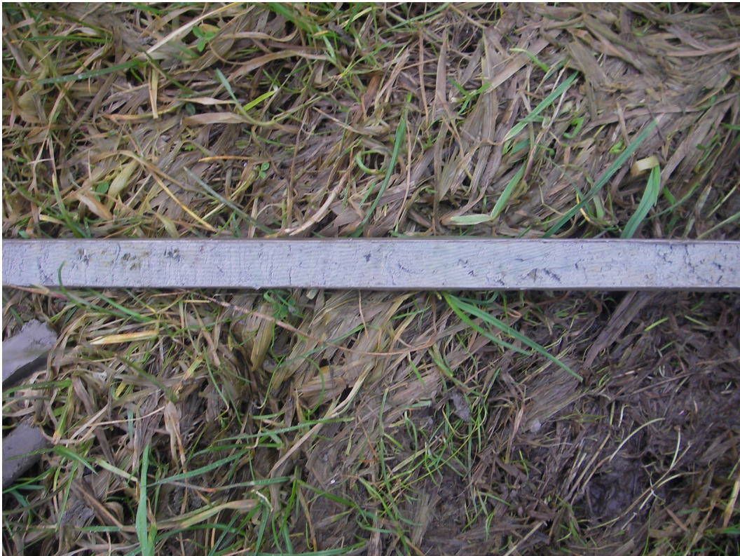
Figuur 6. Franeker, Zevenhuizen, tussen 1 en 3. Foto van het door talrijke zandlaagjes onderbroken kleipakket dat in alle boringen is aangetroffen.
