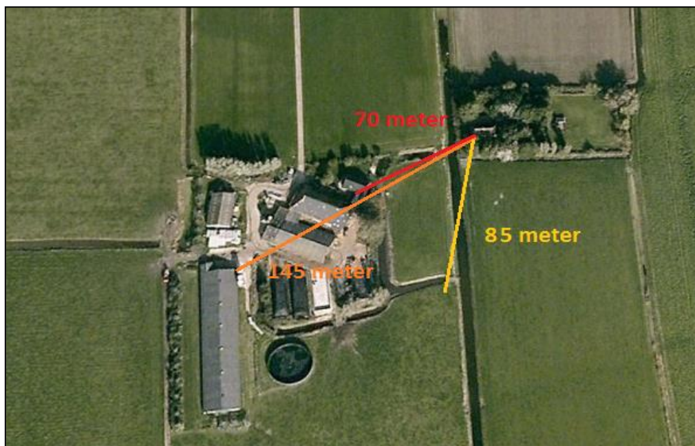
Figuur 7: richtafstanden pluimvee (oranje), rundvee (rood) en kuilvoeropslag (geel) tot geurgevoelige object
