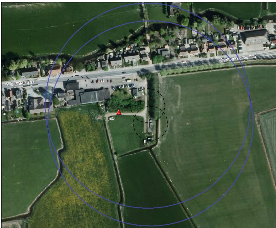
Figuur 5. Invloedsgebieden (blauwe cirkels) en PR10 -6 -contouren (zwarte stippellijn) rondom LPG-tankstation aan de Waling Dijkstrastraat 86
