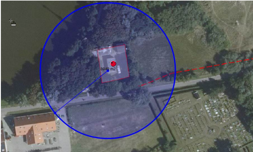
Figuur 4: veiligheidsafstand van gasdrukmeet- en regelstation
