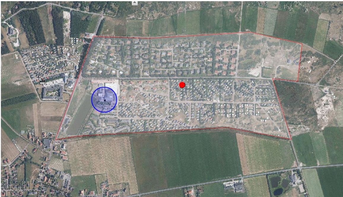
Figuur 5: 100% letaliteitsafstand opslag Chloorbleekloog Vakantiepark Klein Vaarwater
