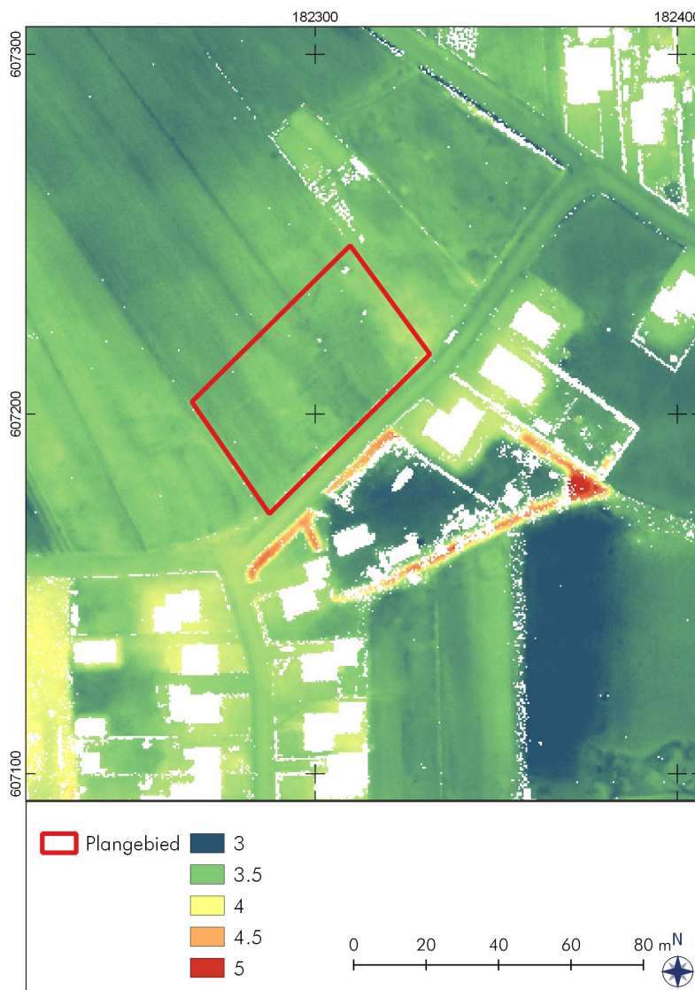
Figuur 4: Buren, Foppedunenweg: Detail van de hoogtekaart. Het plangebied is rood omlijnd. Het terrein loopt iets op naar het oosten. Bron: Actueel Hoogtebestand Nederland 3 (AHN3).
