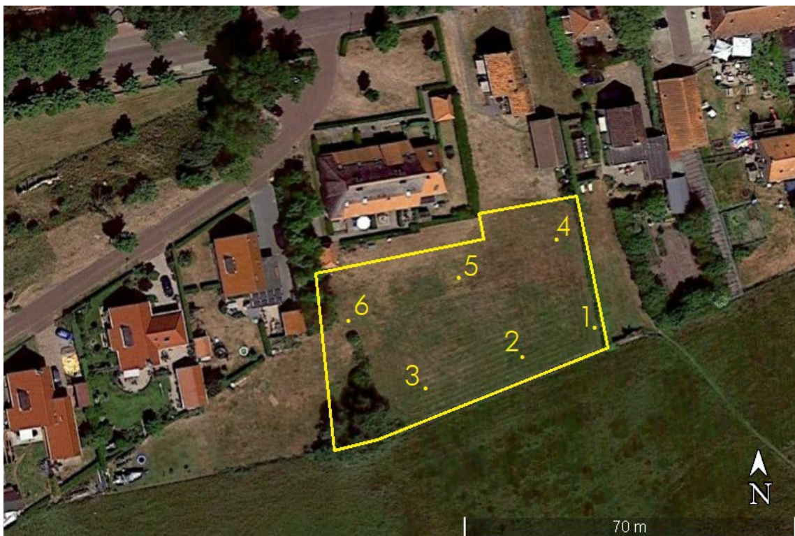
Figuur 7: Nes, Binnendieken: Situatietekening met de boorlocaties. De begrenzing van het plangebied is met een gele lijn aangegeven. De boringen zijn in geel weergegeven met een cirkel en een cijfer 1 tot en met 6. Voor de RD-coördinaten van het plangebied wordt verwezen naar de administratieve gegevens. Naar: GoogleEarth.
