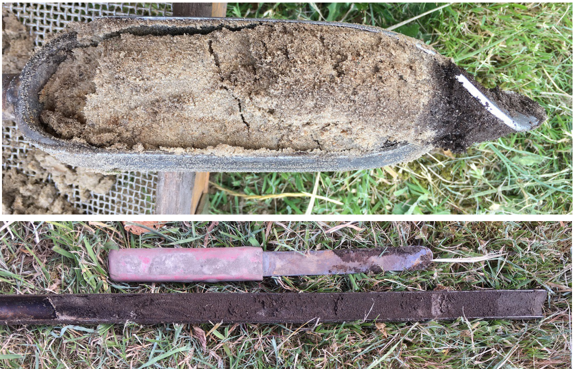
Figuur 8: Nes, Binnendieken: Boring 1. Boven is de scherpe overgang van C-horizont naar sterk zandig donkerbruin veen te zien rond 75 centimeter diepte. De foto onder laat sterk weinig zand zien in de guts. De guts is tot een diepte van 125 centimeter onder het maaiveld gezet en bevat een dun zandbandje tussen 116-117 centimeter diepte en grijs zand op 123 centimeter (rechts op de foto).
