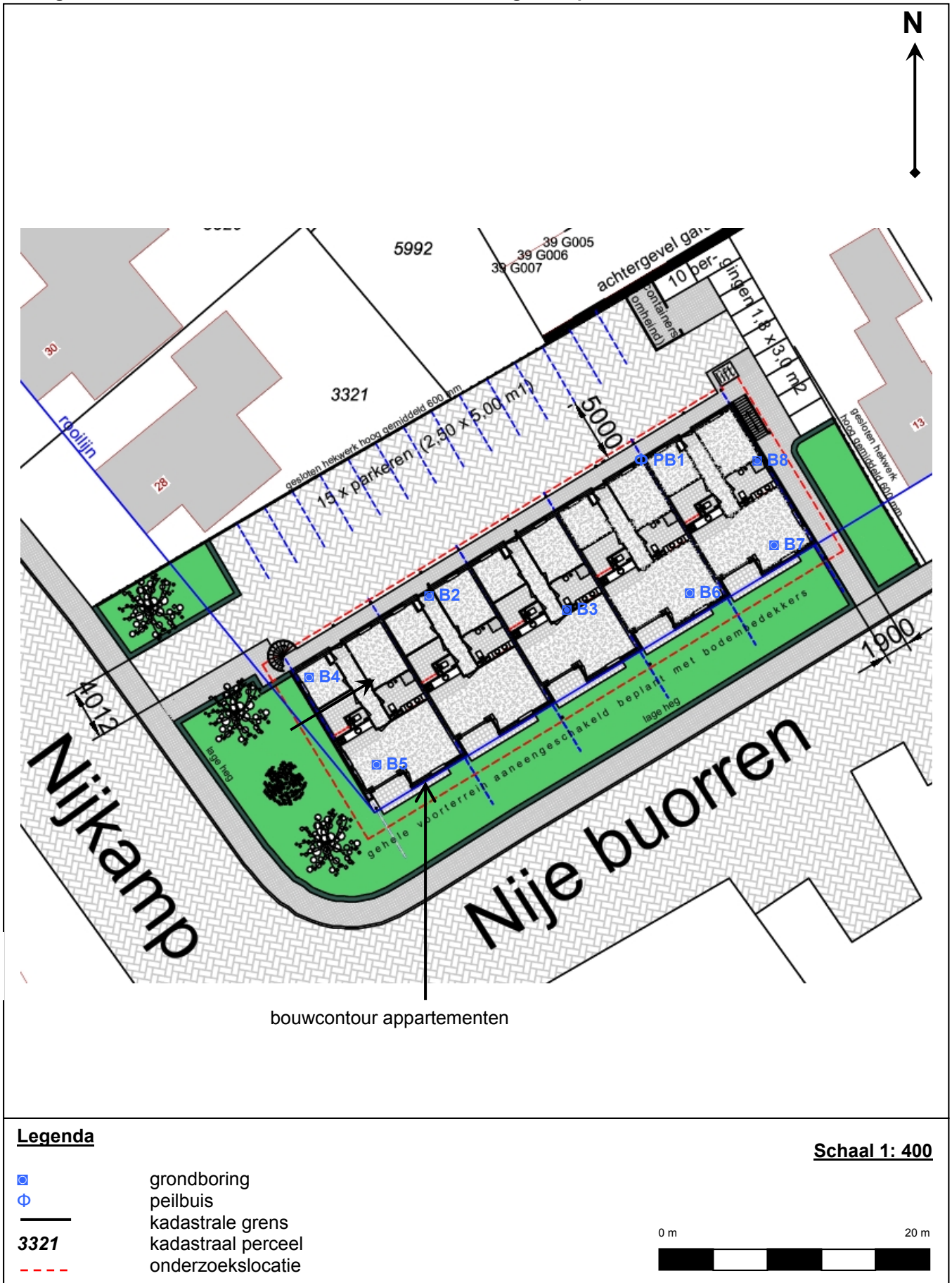
Figuur 2. Locatie-overzicht met de nieuwbouw, boringen en peilbuis
