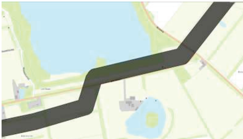
Figuur 23: deel van de visiekaart met daarop aangegeven buisleidingstrook van 70 meter
