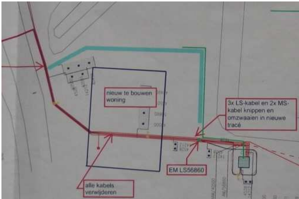
Fig.8: situatie wel of niet omleggen van de elektriciteitskabel (bron: tekening Liander)
