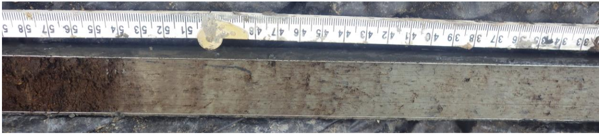
Boring 4: detailopname van de overgang van kwelderafzettingen naar rietveen op 354 cm –Mv.
