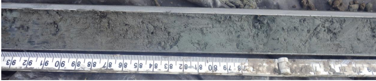
Boring 7: zwak humeuze kwelderafzettingen van sterk siltig zand met brokken sterk zandige klei (183-188 cm –Mv).
