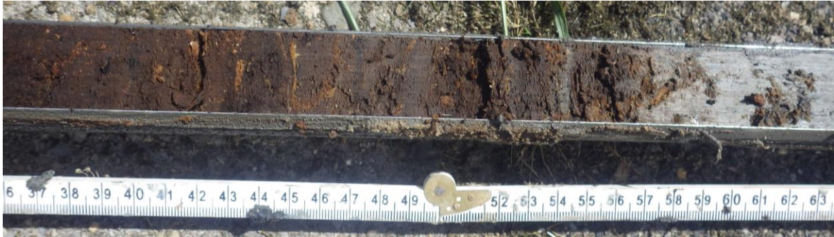
Boring 2: Detailopname van het mineraalarm tot zwak kleilig rietveen met aan de basis zwakzandige en slappe kwelderafzettingen met rietresten. De laagovergang is scherp.
