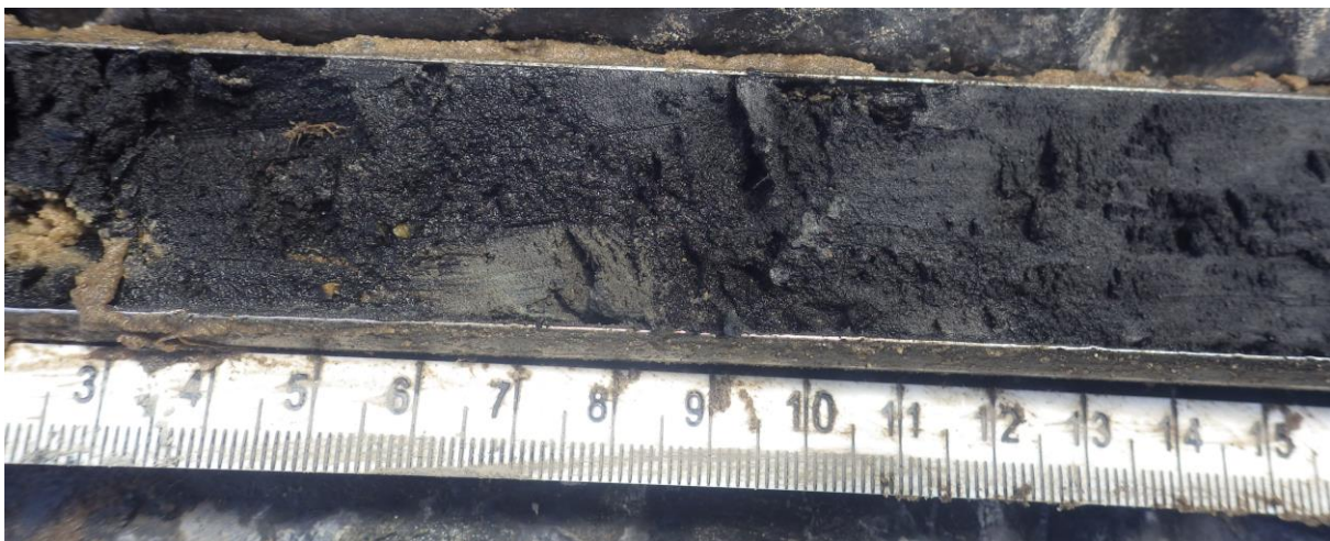
Boring 4: detail van de bijna zwarte sterk humeuze laag op 100-120 cm -Mv (zie ook vorige foto)
