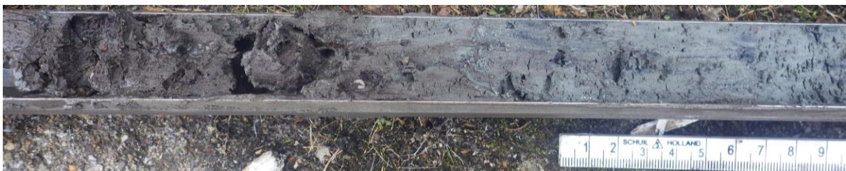
Boring 3: Overgang van mogelijke – omgezette – terplaag met fragmenten rood baksteen en kalkmortel (45-105 cm –Mv) naar blauwgrijze matig tot sterk zandige en matig stevige kwelderafzettingen. Aan de basis lijkt de mogelijk omgezette terplaag c.q. antropogene ophoging zwak venig.
