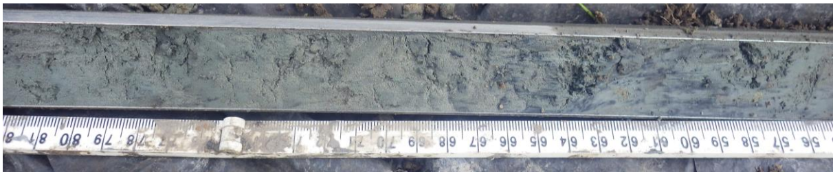
Boring 7: kwelderafzettingen van sterk siltig zand, vermengd met brokken blauwgrijze matig zandige klei 166-183 cm –Mv).
