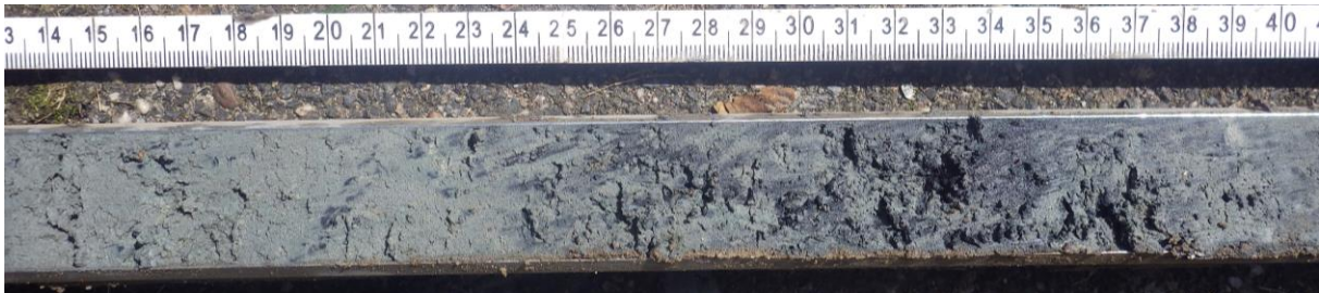
Boring 2: sterk zandige kwelderafzettingen met verteerd organisch materiaal (125-138 cm -Mv).
