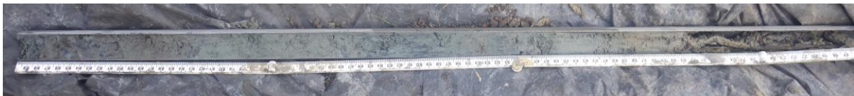
Boring 7: blauw-grijze Wad-/kwelderafzettingen tussen 140-200 cm –Mv. Tussen 166-183 cm –Mv bevat het zand kleibrokken.
