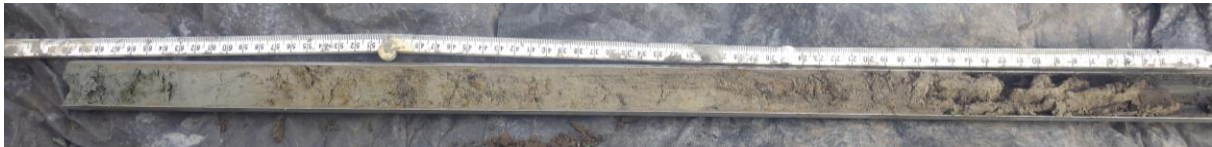
Boring 7: sterk zandige klei met roestvlekken op 105-130 cm –Mv.
