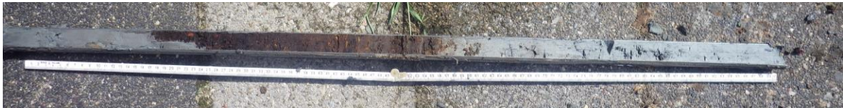
Boring 2: Mineraalarm tot zwak kleilig rietveen met aan de basis zwakzandige en slappe kwelderafzettingen met rietresten.
