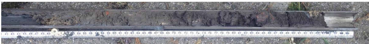
Boring 3: Mogelijke – omgezette – terplaag met fragmenten rood baksteen en kalkmortel (45-105 cm –Mv).
