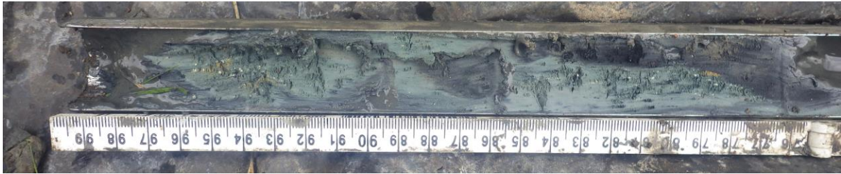
Boring 7: groen-blauwgrijze klei met kalkachtige witte brokjes/vlekjes (377-400 cm –Mv).
