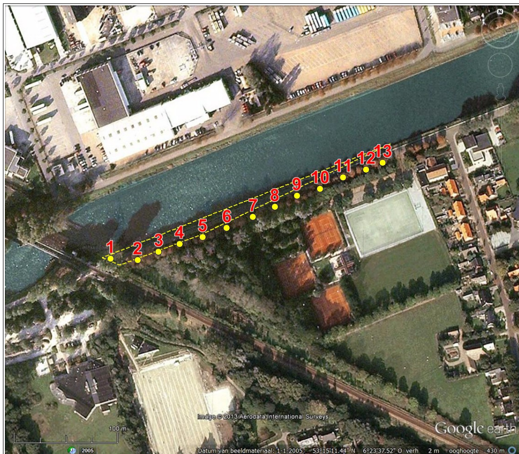
Figuur 8: Zuidhorn, Spoorbrug: boorpuntenkaart. De genummerde punten zijn de locaties van de dertien boringen.
