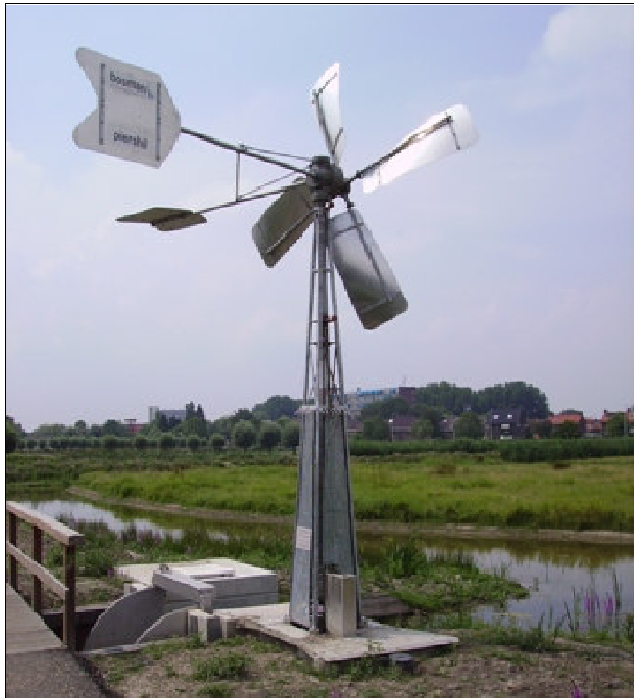
Voorbeeld watermolen, aangedreven door windenergie
