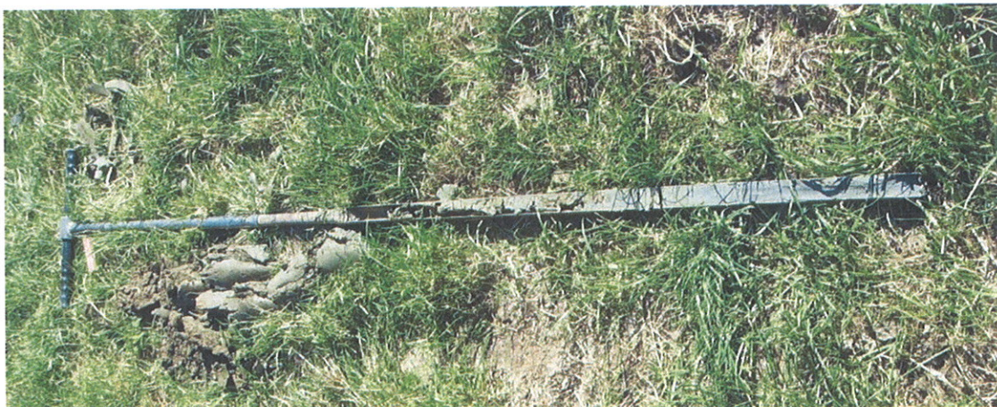
Afbeelding 10. Beeld van boring 3, met bovenin de bouwvoor en daaronder klei dat overgaat in zand
