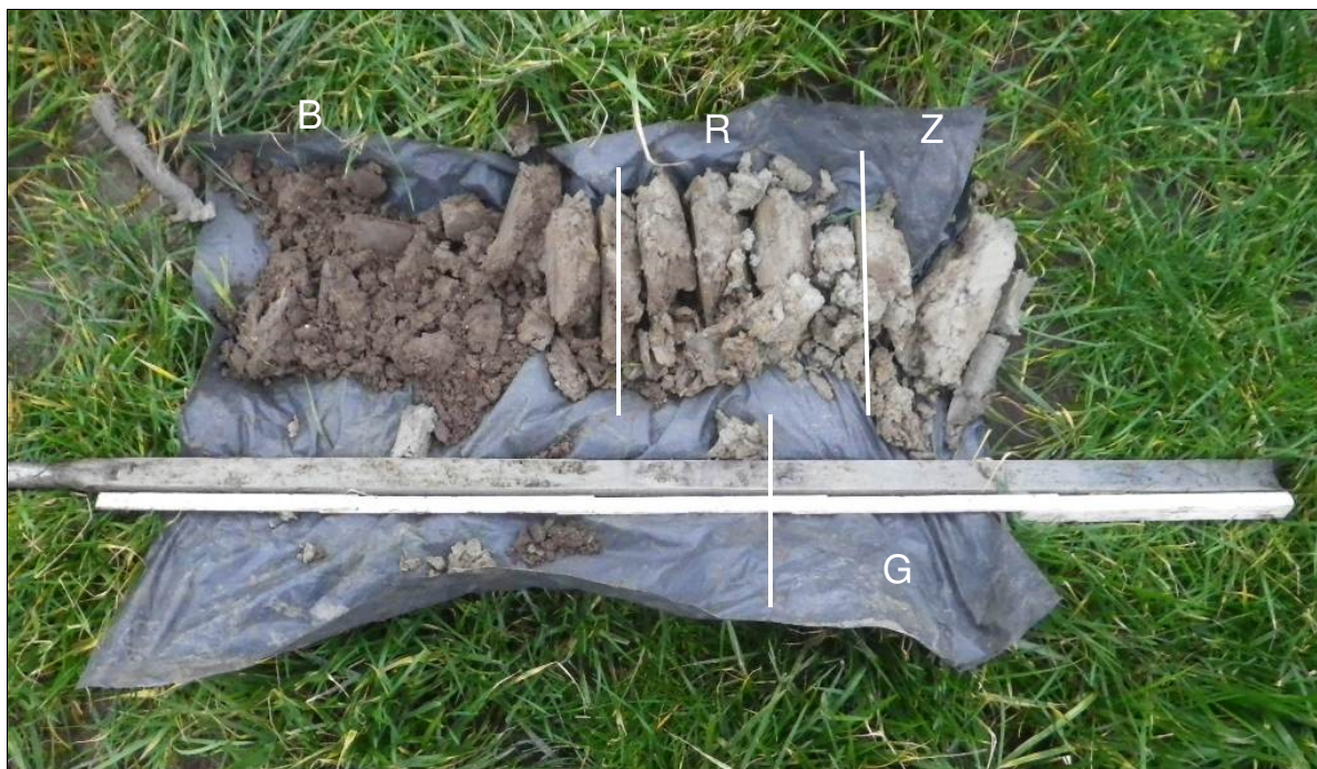
Afbeelding 3. Beeld van boring 3 met B: bouwvoor; R: sterk siltige klei, Z: zwak siltige klei en G: gelaagde klei
