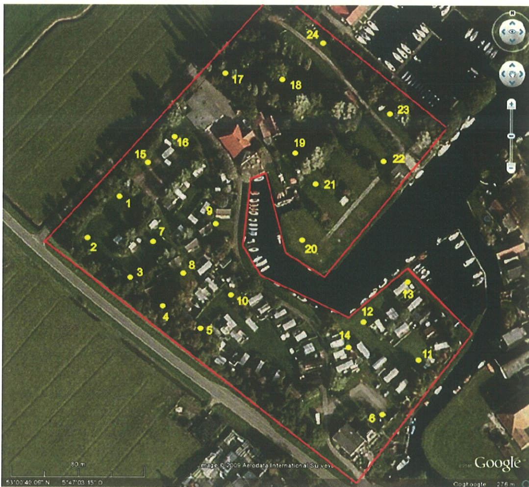
Figuur 6: Terkaple, Waterpark: situatietekening met de boorlocaties [Naar: Google Earth]. De genummerde punten geven de uitgevoerde boringen weer. Het plangebied is met een rode lijn aangegeven (RD-coördinaten plangebied: N - 181,650/558,480; O - 181,785/558,310; Z - 181,710/558,190; W -181,520/558,335).
