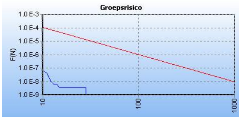
Figuur 14: FN-curve aardgastransportleiding N-501-42 (huidige situatie)
