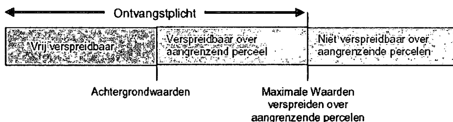
FIGUUR 3: NORMSTELLING VOOR VERSPREIDEN VAN BAGGERSPECIE OVER AANGRENZENDE PERCELEN
