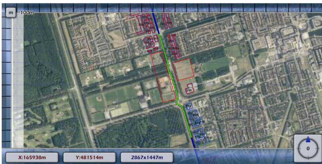
Afbeelding 4. Kilometer leiding met hoogste overschrijdingsfactor ten opzichte van de oriënterende waarde. (groene lijn)
