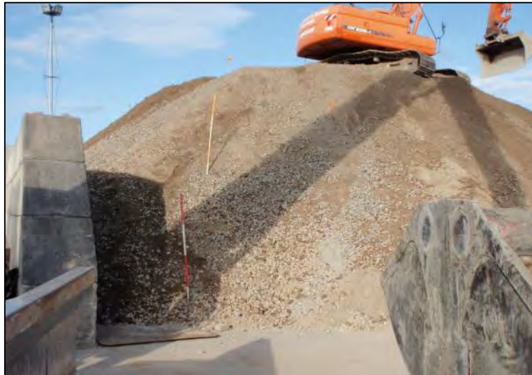
P2016-0548, Partijkeuring menggranulaat Zeewolde, foto 1
