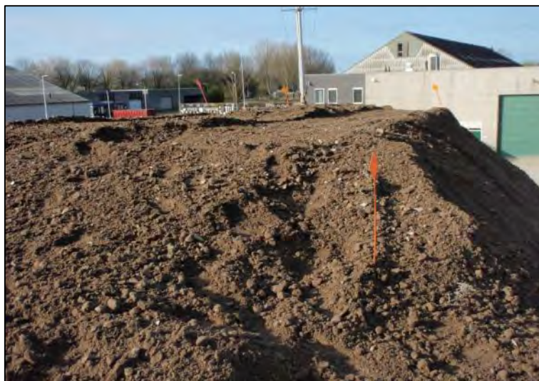
P2016-0548, Partijkeuring menggranulaat Zeewolde, foto 3
